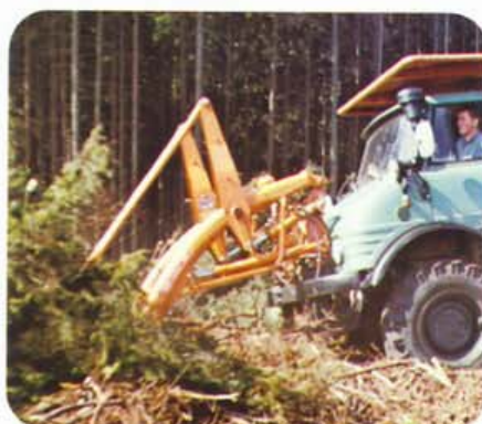
Chargeur frontal avec fourche pour le déblaiement des déchets d'abattage.
