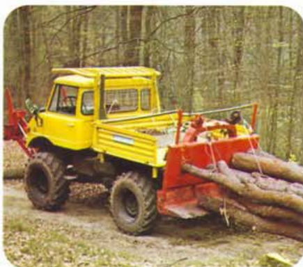
Equipement de débardage avec dispositif spécial pour débardage du bois léger pour U 800 et U 900.
