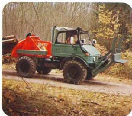
Equipement spécial de débardage du bois léger avec position surélevée des poulies guide - câbles et grosse bèche d'appui AR pour U 600.
