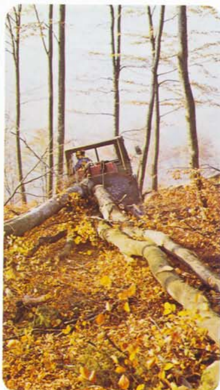
Au moyen d'un système de câbles munis de crochets les grumes sont groupées en faisceaux pour être transportées.
